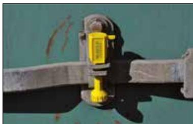
Le HanaLock™ est, avec le logement de cadenas vers le haut, inséré dans la serrure du conteneur. De cette manière, il n'y a aucun risque de saleté dans la mécanique ou de dépôt dans le logement du cadenas pouvant affecter les parties métalliques du cachetage.
