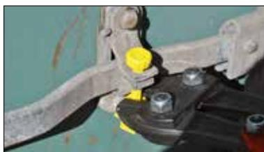
Les scellés de barrière ne peuvent être retirés qu'à l'aide d'une pince coupante ou d'une cisaille.
