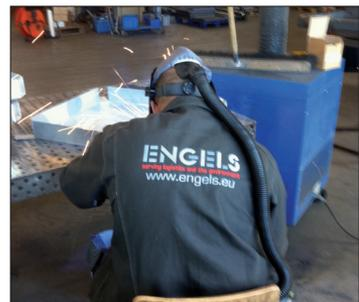
**Soudage de l'aluminium. Beaucoup de nos produits sont fabriqués en aluminium en raison de sa légèreté et de sa bonne résistance à la corrosion.**
