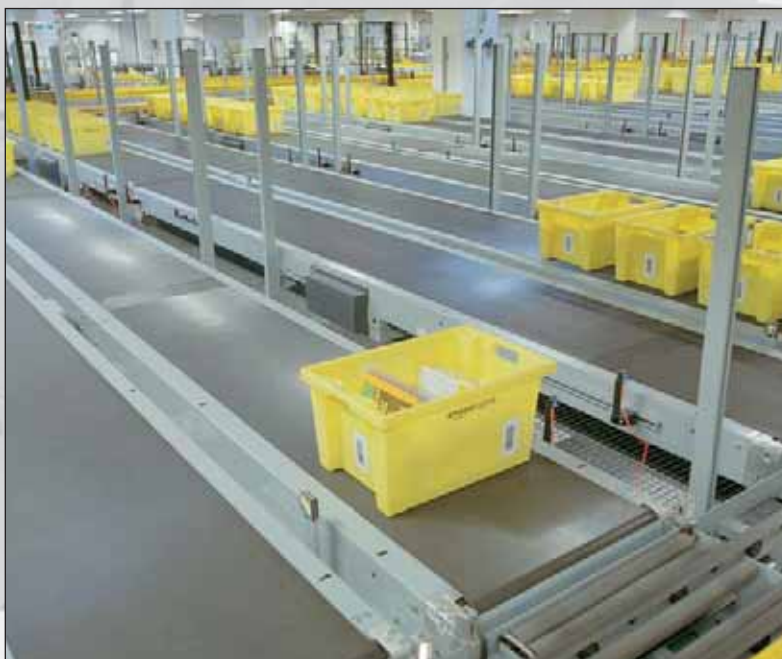
Bacs ESA dans un entrepôt automatisé dédié à la distribution de livres et de cd. (photo Vanderlande Industries).
