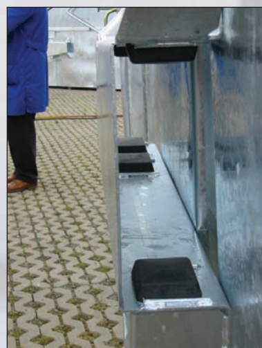
Dans la prise, il y a des coussins pour réduire le bruit
